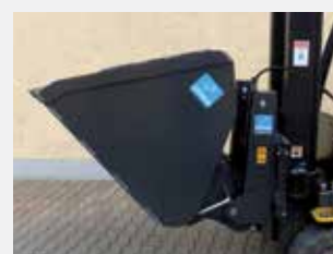
Abb. Kipprahmen „EKR“ mit angebauter Schüttgutschaufel
