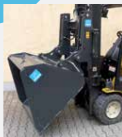
Abb. Kipprahmen „EKR“ mit angebauter Schüttgutschaufel
